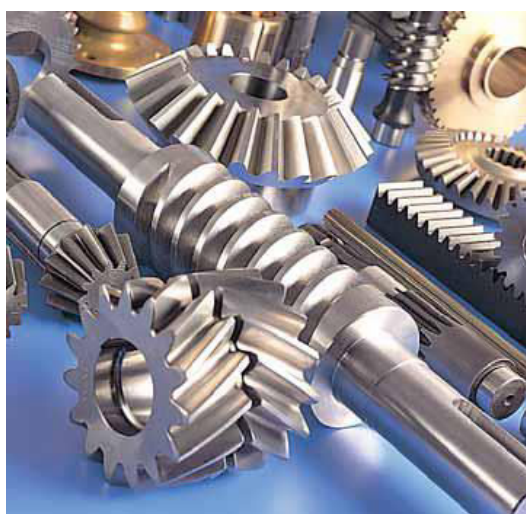
Fig. 7.15 Prelucrări și piese cu dantură – prelucrate pe mașini cu CNC
