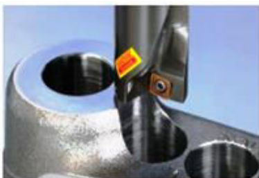
Fig. 5.20 Selectarea tipului de burghiu (recomandări ale firmei SANDVIK COROMANT) - continuare [http://www.sandvik.coromant.com]
