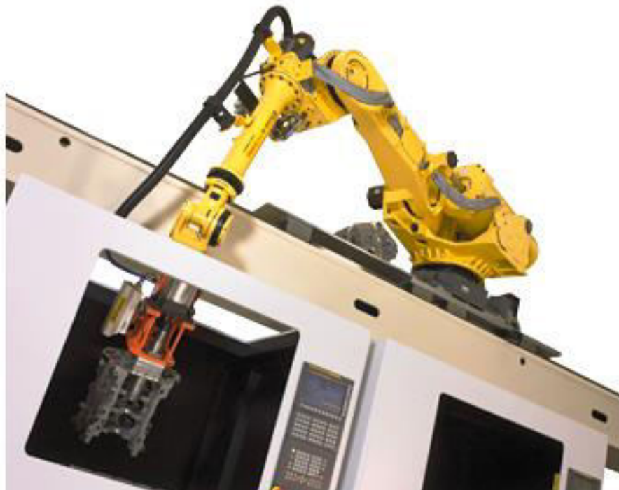
Fig. A2 Robot industrial pentru încărcarea – descărcarea pieselor prelucrate pe centre CNC
