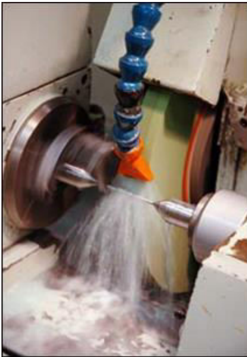
Fig. 6.6 Tipuri de lichide de răcire – ungere pentru prelucrări prin rectificare
