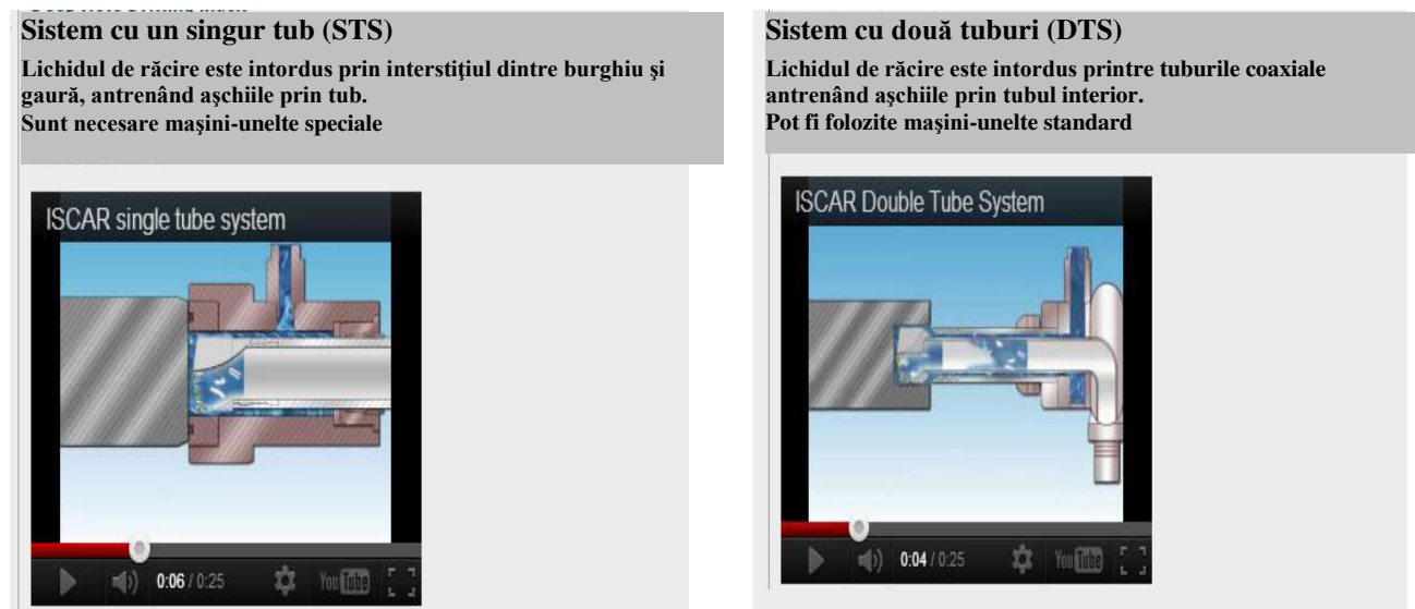
Fig. 5.22 Tipuri de sisteme pentru trimiterea lichidului de răcire – ungere [ http://www.iscar.com ]
