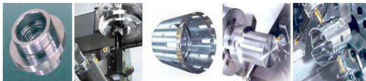
Fig. 4.20 Prelucrări și piese prelucrate pe strung și centru de prelucrare prin strunjire cu CNC
