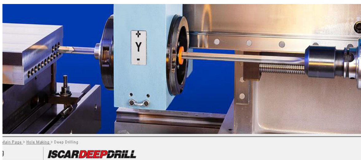
Fig. 5.16 Scule pentru prelucrări tip găurire (firma ISCAR) [ http://www.iscar.com ]
