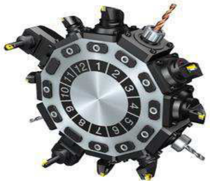
CDI, discul de interfață Coromant (Coromant Disc Interface) funcționează între turelă și unitățile de fixare
