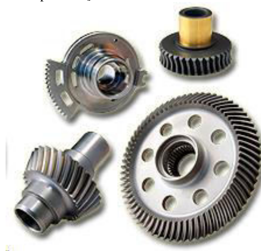
Fig. 7.15 Prelucrări și piese cu dantură – prelucrate pe mașini cu CNC
